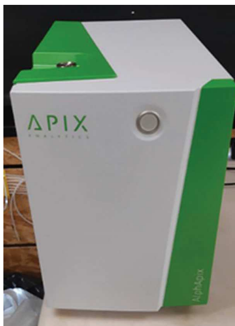
Le chromatographe en phase gazeuse AlphaPix développé par Apix Analytics intègre la technologie propriétaire NGD améliorée, avec le contrôle de la température du détecteur.
